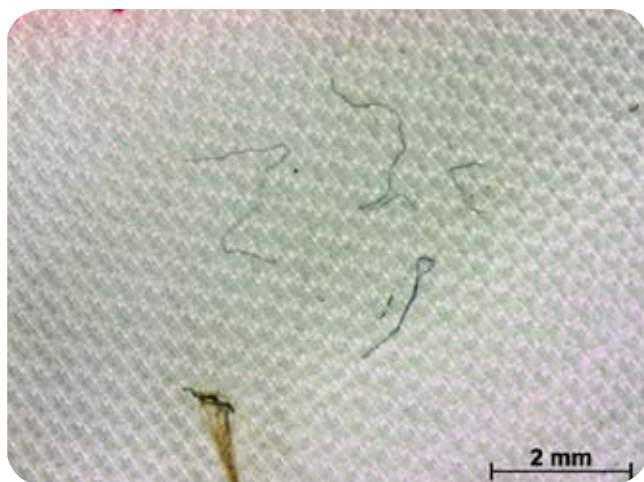
Slika 13: Vlakna, izolirana iz vzorca silaže kmetije Metelko; silaža je bila hranjena v Silograss foliji.
