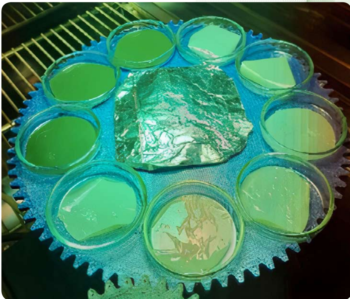
Slika 17: Prikaz vrteče podlage in na njej nameščenih vzorcev, izpostavljenih UV svetlobi.
